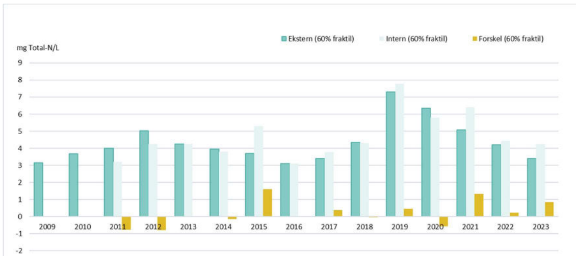
Figur 14 Gns. årlige udløbskoncentrationer registreret ved interne og eksterne analyser på Stegholt Renseanlæg.
